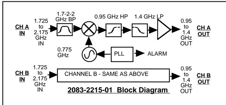
**FIGURE 1.2 Block Diagram**
